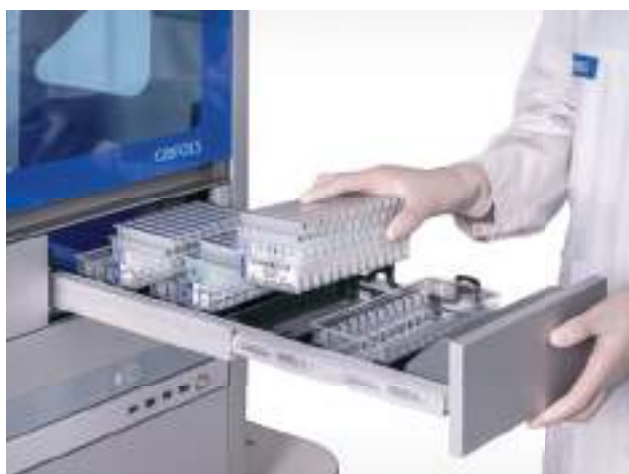
Zona de carga de tarjetas DG Gel
